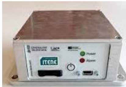
Figura 1. Dispositivo de medición data recorder desarrollado por ITENE.
