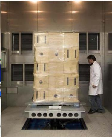
> Cámara climática para uso con vibración
