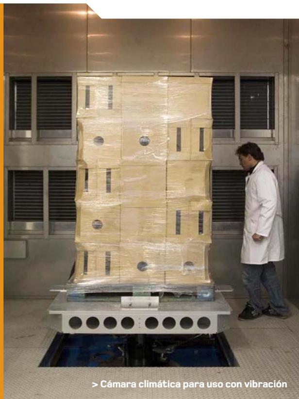
> Cámara climática para uso con vibración
